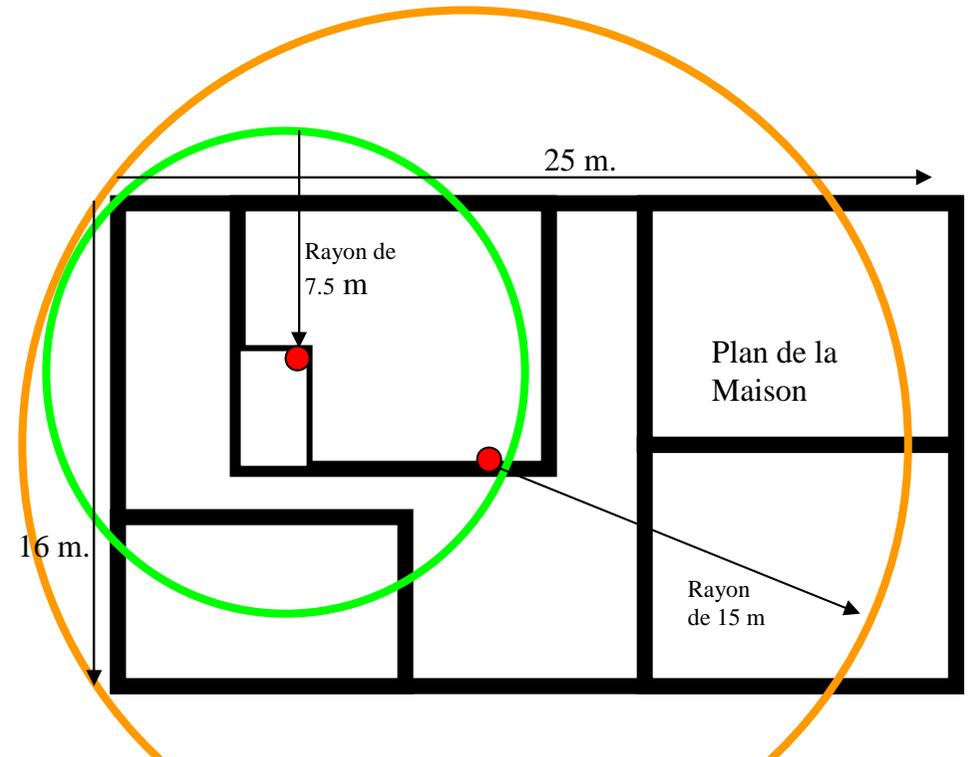
Suivant le type de l'appareil, centrer celui-ci en fonction du rayon de traitement. Le lobe du champ magnétique de correction est comparable à la forme d'une citrouille. Pour une meilleure efficacité, la hauteur de l'emplacement de pose devra être la suivante :
